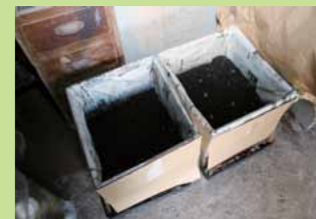
コンポストとは、生ごみなどの有機ごみを微生物や電気を使って短期間のうちに堆肥化し、生ごみを減量化する容器
