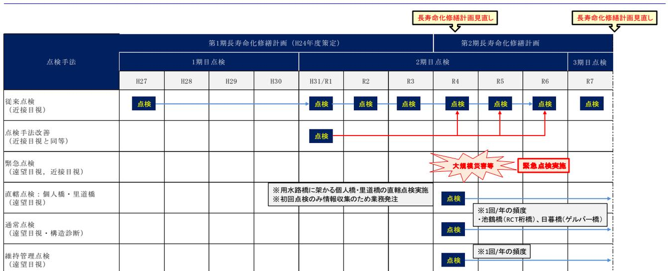
図-2.3 長寿命化修繕計画と点検サイクルイメージ
