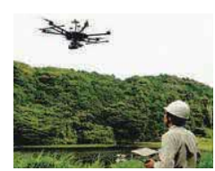
▲②ドローン (UAV) による測量
