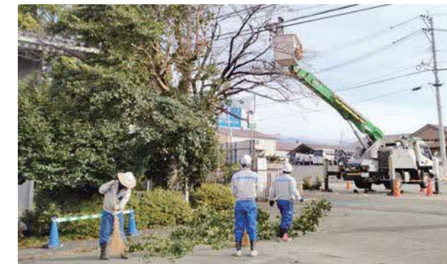
高所作業車を生かした剪定作業
