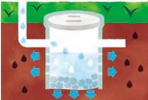
雨水浸透ますの仕組み
