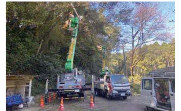
高所作業車を生かした高木剪定作業
