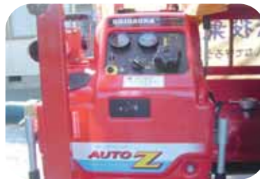
導入された小型動力ポンプ
