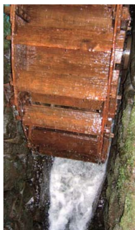
工場内の木製水車 制作者 藤原清司氏 直径3.2m 5馬力
